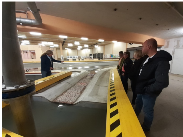
Die Modellversuche dienen der Optimierung des Projekts Rhesi sowie der genaueren Bestimmung aller Projektkosten.
